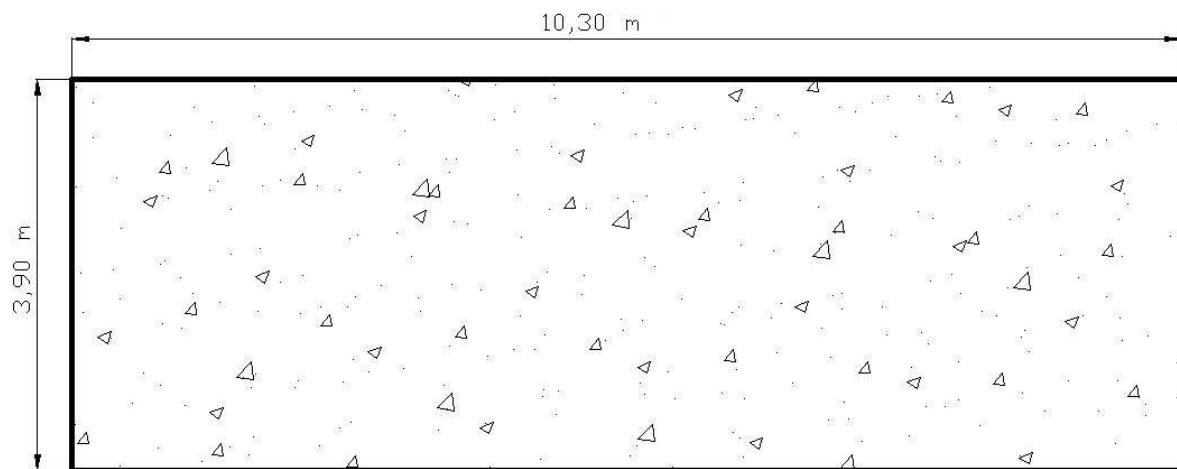
Grosimea placii de beton va fi de 15 cm, simplu armata
