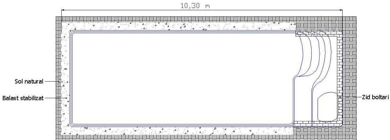
**De jur imprejurul piscinei si pe toata adancimea ei se va pune balast stabilizat. Pentru piscina STEFANIE 10x3,6x1,5 m sunt necesari aprox. 14 mc balast cu granulatia 0-16 mm.Pentru fiecare 1 mc de balast se adauga 160 kg ciment.**
