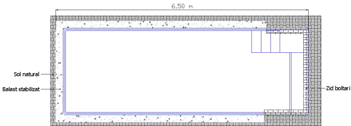
**De jur imprejurul piscinei si pe toata adancimea ei se va pune balast stabilizat. Pentru piscina San Marino 6x2,95x1,5 m sunt necesari aprox. 7 mc balast cu granulatia 0-16 mm. Pentru fiecare 1 mc de balast se adauga 160 kg ciment.**
