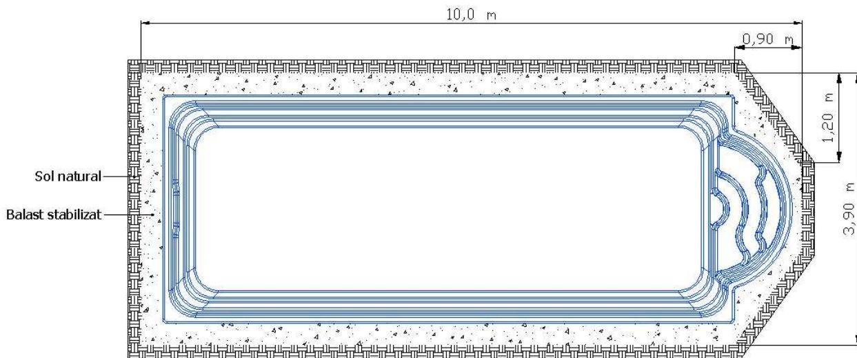
**De jur imprejurul piscinei si pe toata adancimea ei se va pune balast stabilizat. Pentru piscina ROMA 9,7x3,6x1,5 m sunt necesari aprox. 18 mc balast cu granulatia 0-16 mm (nisip si pietris) .Pentru fiecare 1 mc de balast se adauga 120 - 160 kg ciment.**
