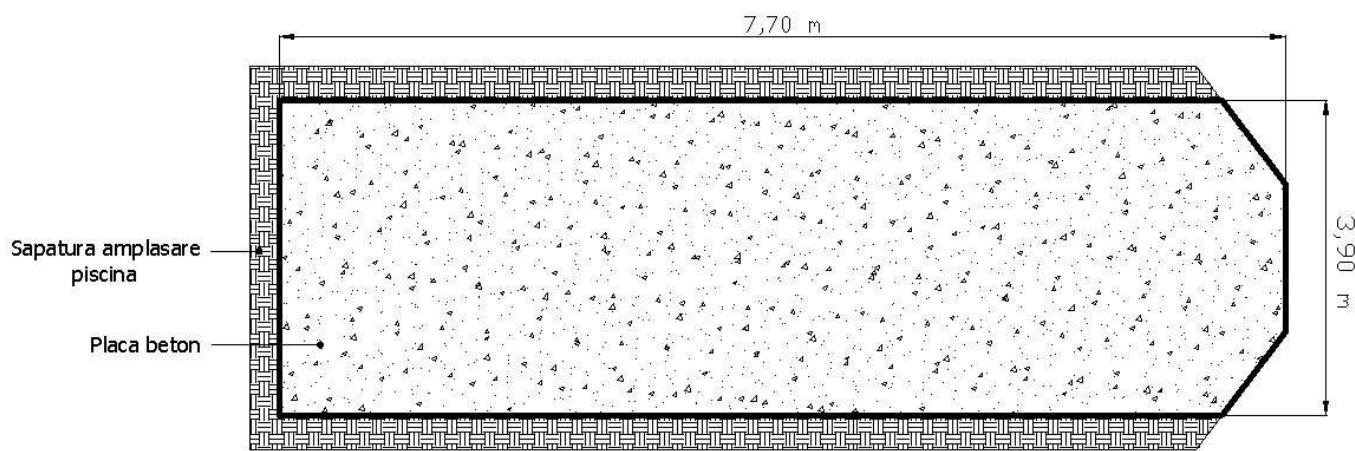
Grosimea placii de beton va fi de 15 cm, simplu armata
