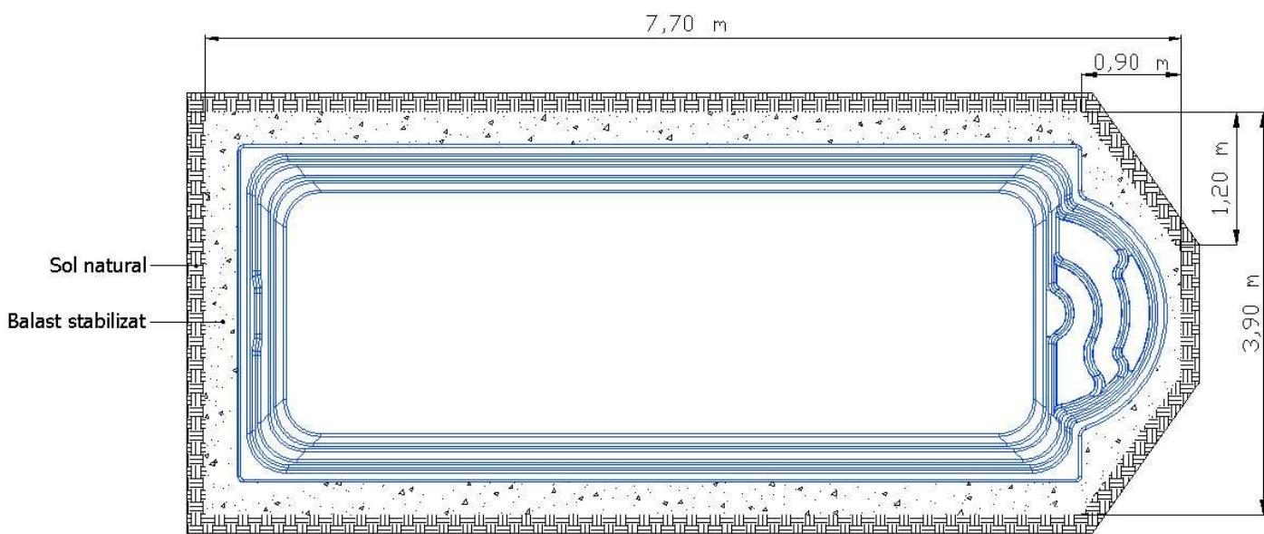
**De jur imprejurul piscinei si pe toata adancimea ei se va pune balast stabilizat. Pentru piscina ROMA 7,5x3,6x1,5 m sunt necesari aprox. 12 mc balast cu granulatia 0-16 mm (nisip si pietris). Pentru fiecare 1 mc de balast se adauga 120 - 160 kg ciment.**
